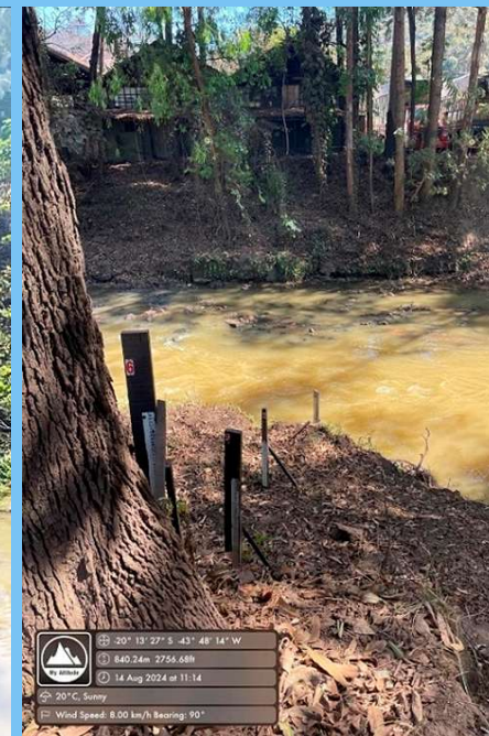
Réguas linimétricas a montante da ponte metálica sobre o rio
