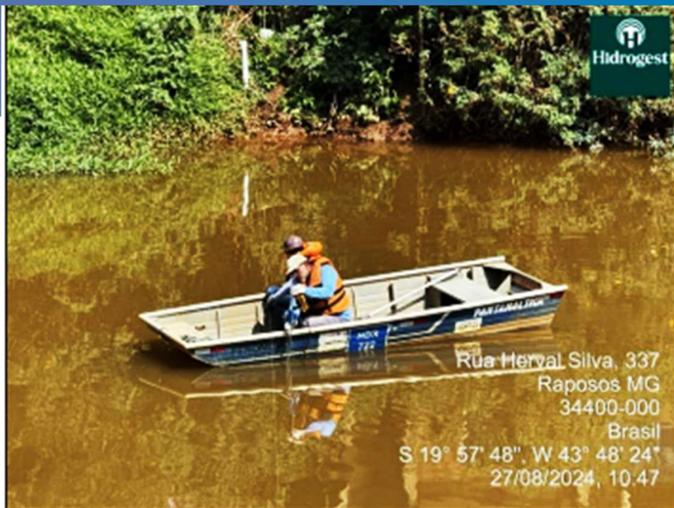
Figura 5 - Medição de descarga líquida estação Raposos – 27/08/24
