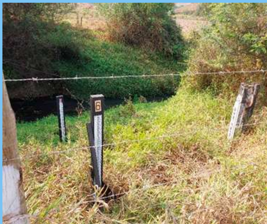
Localização da antiga estação no Rio Maracujá e réguas linimétricas
