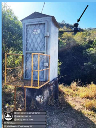
Abrigo dos equipamentos eletrônicos e pluviômetro; entrada da tubulação de sensores no rio e réguas linimétricas
